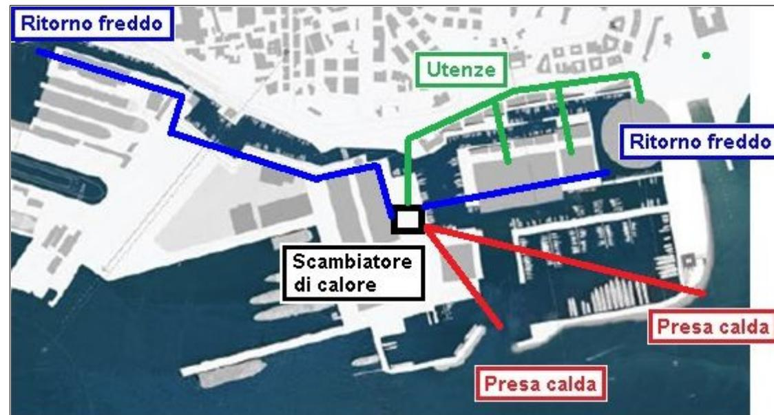
Nel nostro caso, il sistema sarà ad anello aperto, con presa calda e il ritorno freddo posizionati in modo da incentivare per via naturale le correnti necessarie per garantire il ricambio delle acque interne del porticciolo e del canale di collegamento con porta Siberia, nel rispetto delle norme nazionali e locali che disciplinano la materia.
